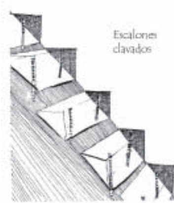
Escalones de madera asegurados a una pared de roca con varillas de acero
