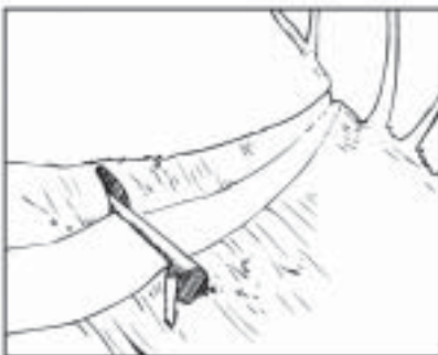
El tronco de una barra de agua empotrado en una trinchera a veces se puede asegurar con estacas de madera
